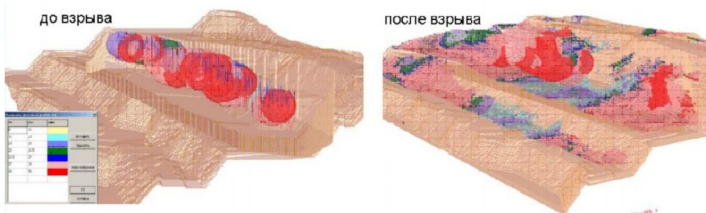
Рис.2. Распределение полезного компонента ( Fe_{общ} ) в буровзрывном блоке
