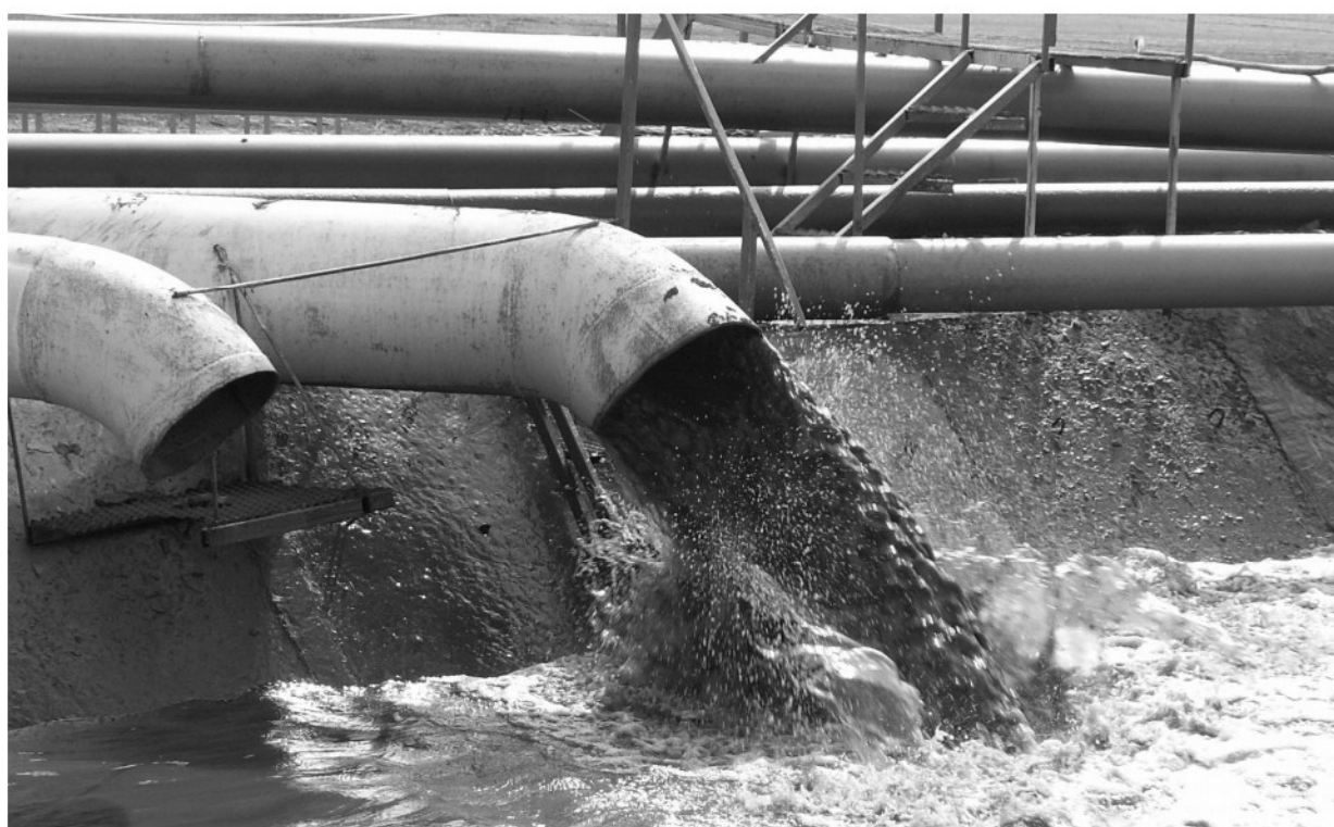
Рис.2. Выпуск железной руды при скважинной гидродобыче
