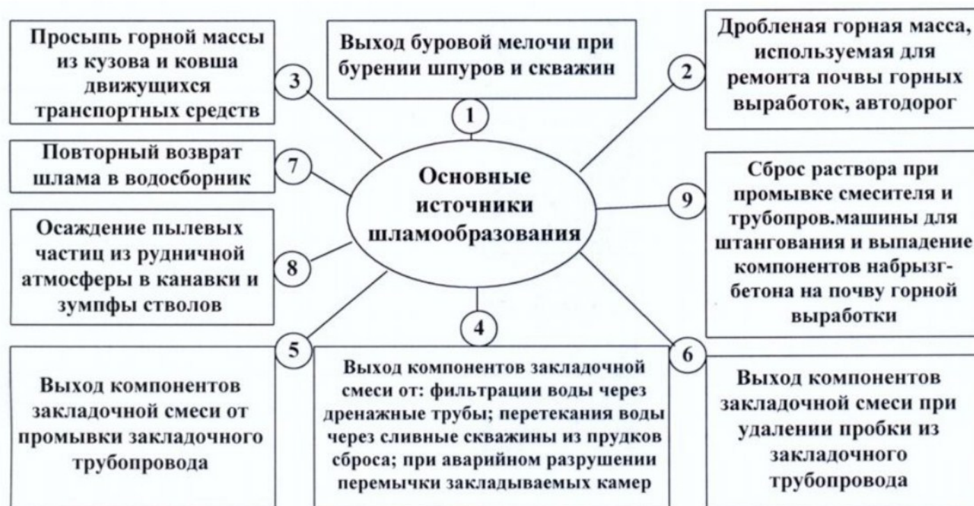
Рис. 3. Основные источники шламообразования на подземных рудниках
